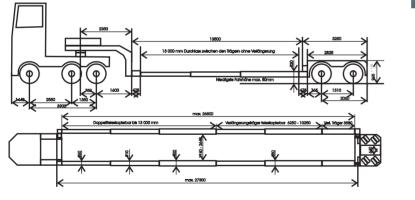
Nutzlast ohne Träger 21 000 kg Nutzlast kurze Träger 20 000 kg (Bettlänge max. 16500 mm) Nutzlast lange Träger 18 000 kg (Bettlänge max. 23 250mm) Nutlast alle Träger 16500 kg (Bettlänge max. 26 800mm)
