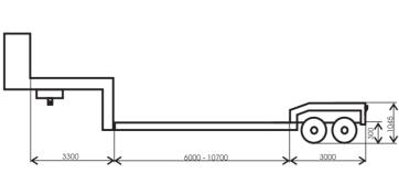
Sattel bei unteilbaren Gütern im Tiefbett bis auf 10700 mm ausziehbar Nutzlast max. 23 000 kg
