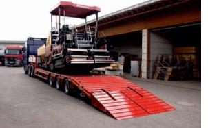
Sattel bei unteilbaren Gütern im Tiefbett mit Einbauträgern bis auf 20250 mm teleskopierbar Nutzlast ohne Einbauträger 25 000 kg Nutzlast mit Einbauträger 22 000 kg Absattelbarer Schwanenhals zur Beladung von Baumaschinen
