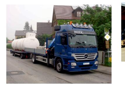
Tieflader mit ausziehbarem Heck für Ladungen bis max, 10 500mm,
